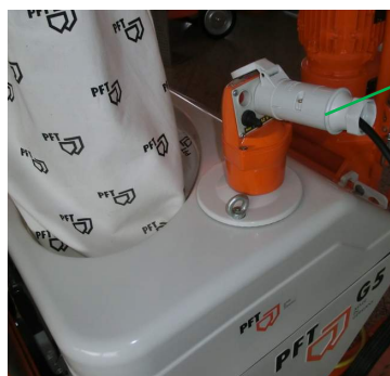
Sl. 33: Odstranjevanje krmilnega vtiča
