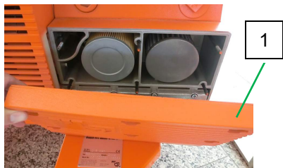
Sl. 45: Odvijanje pokrova filtra
