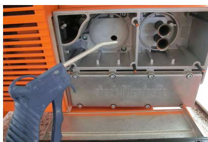
Sl. 48: Čiščenje ohišja filtra
