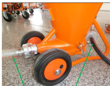
Sl. 14: Priključitev transportne cevi
