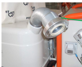
Sl. 14: Priključitev transportne cevi
