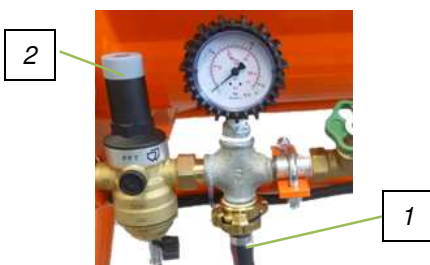
Sl. 1: Vodovodni priključek
