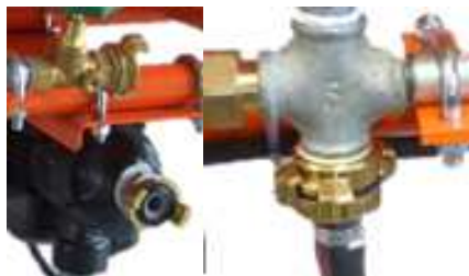
Sl. 50: Sito lovilca umazanije v dovodu za vodo
