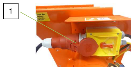
Sl. 11: Priključek za električni tok
