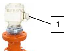
Illustration 37 : fermer le clapet de la sortie du silo
