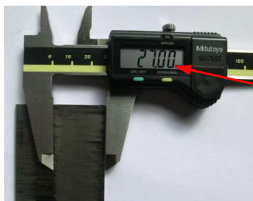
Illustration 49 : Contrôler la largeur des glissières
