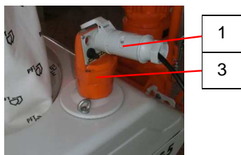
Illustration 19 : Raccorder le câble de commande
