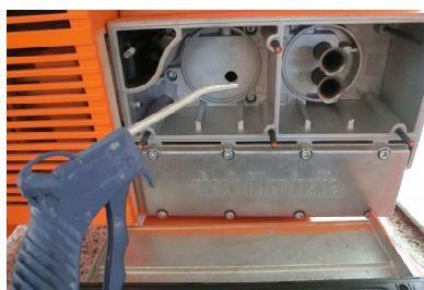
Illustration 46 : Nettoyer le boîtier du filtre
