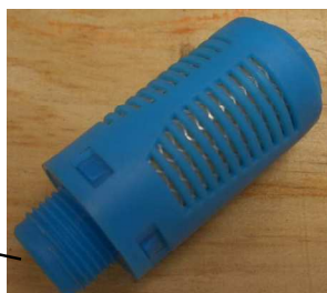
Illustration 48 : Nettoyer la cartouche filtrante à l'air comprimé
