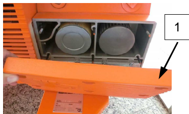
Illustration 43 : Desserrer le couvercle du filtre
