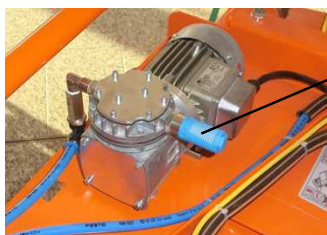
Illustration 47 : Nettoyer la cartouche filtrante
