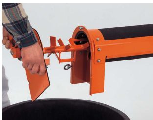
Kuva 41: Sekoitusakselin poistaminen
