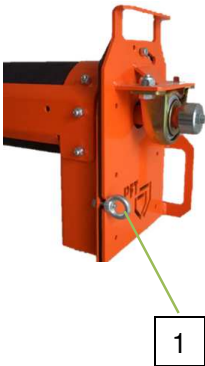
Kuva 40: Rengasmutterin irrottaminen
