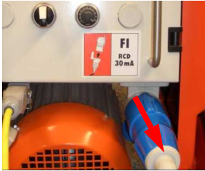
Kuva 50: Liitäntäjohtojen poistaminen
