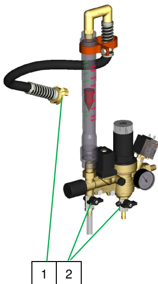
92. ábra: Vízellátás leválasztása
