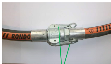
74. ábra: Oldja ki a csatlakozót
