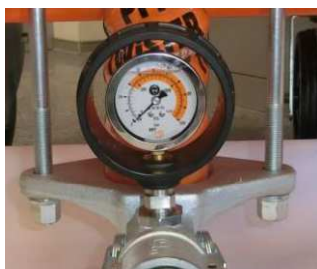
44. ábra: Habarcsnyomás mérőműszer
