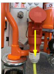
97. ábra: Csatlakozókábel eltávolítása
