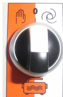
13. ábra: A vízszivattyú üzemmódjai
