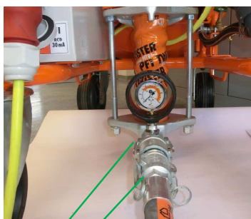
55. ábra: A habarcstömlő csatlakoztatása
