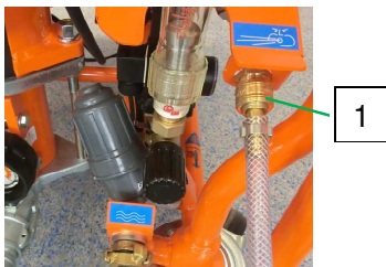
57. ábra: A levegőtömlő csatlakoztatása
