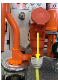
Joon. 97: Ühenduskaabli eemaldamine
