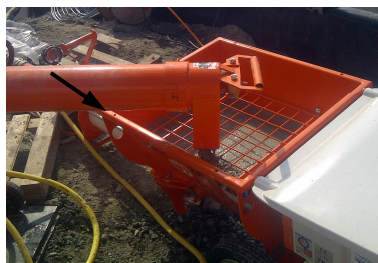
26. ábra: Anyag töltése a tartályba
