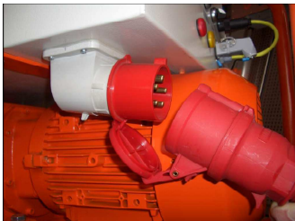
52. ábra: Csatlakozókábel eltávolítása
