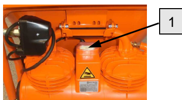
32. ábra: Levegőkompresszor
