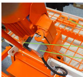
图 71：打开电机翻转法兰
