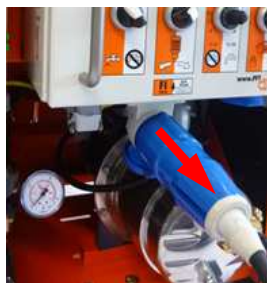
图 88：取下连接电缆
