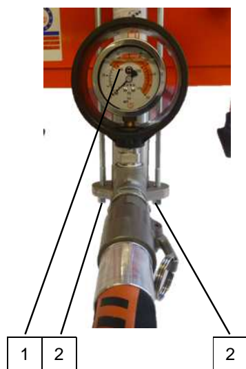
图 65：检查砂浆压力
