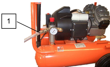
图 49：连接空气软管
