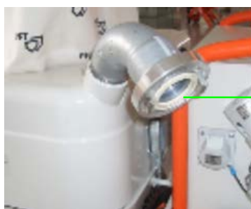
Ábra 19: A szállítótömlő csatlakoztatása
