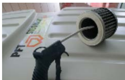
Ábra 61: Szűrőpatronok tisztítása
