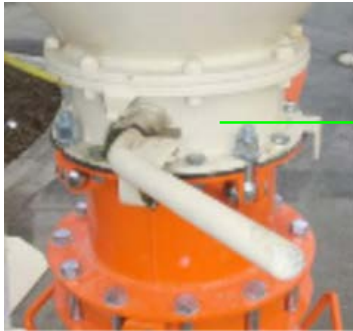
Ábra 22: A siló kiadagoló szelepének nyitása
