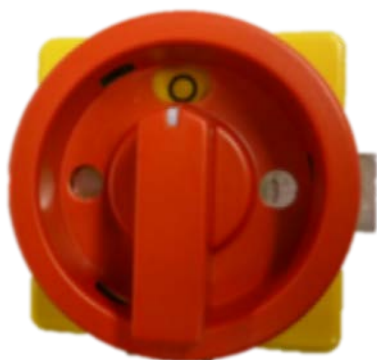
Ábra 28: Fő irányváltó kapcsoló a „0” állásba
