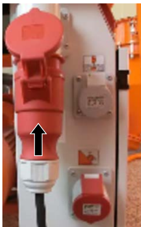
Ábra 14: Áramellátás csatlakoztatása
