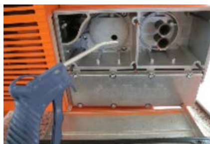
Figura 62: Curățați carcasa filtrului
