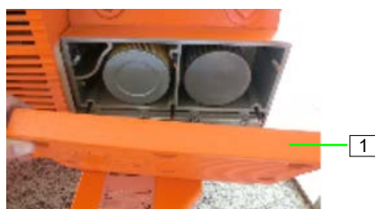
Figura 59: Desfaceți capul filtrului
