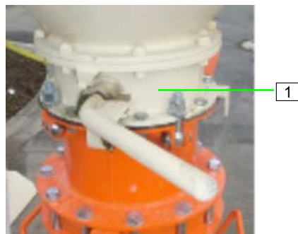
Figura 22: Deschiderea clapetei de evacuare a silozului
