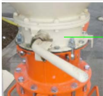
Figura 39: Închiderea clapetei de evacuare a silozului
