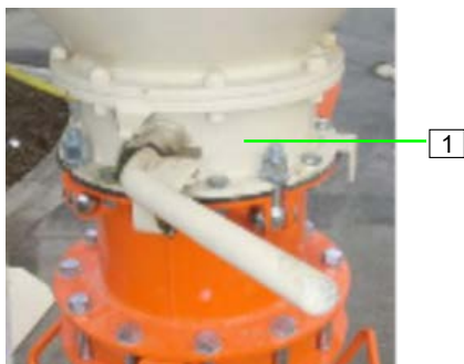
Figura 32: Închiderea clapetei de evacuare a silozului
