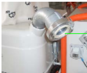
Figura 19: Racordarea furtunului de transport
