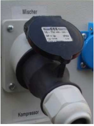
Şek. 25: Karıştırıcı motoru konnektörü
