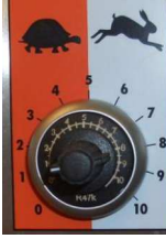
Şek. 48: Potansiyometre
