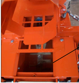
Şek. 70: Pompa haznesini temizleyin
