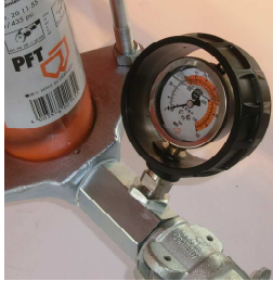
Şek. 16: Harç basıncı manometresi
