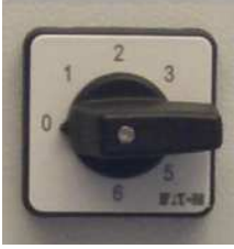
Şek. 15: Seçim anahtarı Karıştırıcı boşta çalışma konumu
