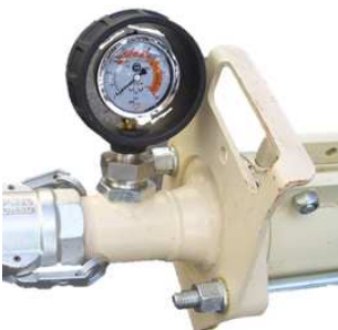
Şek. 42: Harç basıncı manometresi
