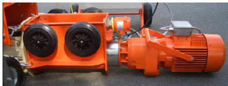
Şek. 17: Pompa ünitesinin sökülmesi
