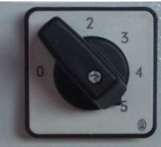
Şek. 14: Seçim anahtarı Pompa ters basınç konumu
