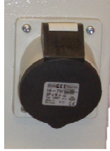
Şek. 30: Pompa motoru konnektörü
