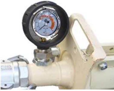
Şek. 46: Harç basıncı manometresi
