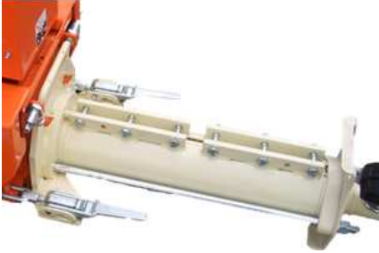
Şek. 83: Stator tekrar sıkılabilir
