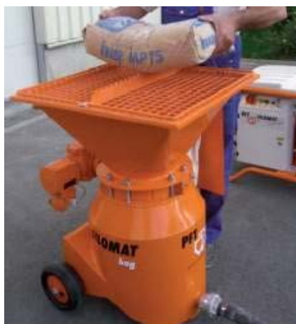
slika 23: Punjenje materijalom u vreći
