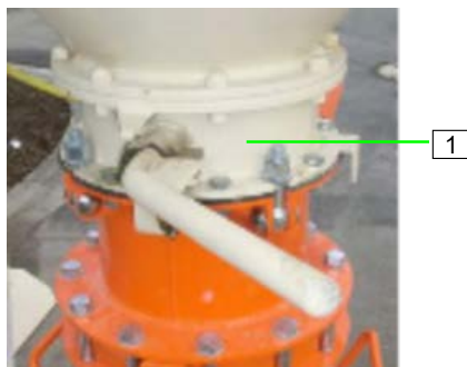
slika 32: Zatvaranje ispusnog poklopca silosa
