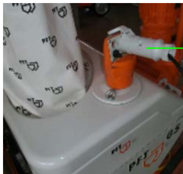
slika 30: Izvući upravljački utikač
