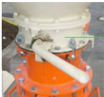
slika 22: Otvaranje ispusnog poklopca silosa
