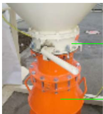
slika 18: Povezivanje posude za materijal
