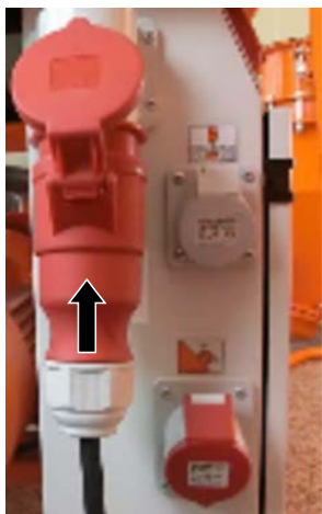
slika 14: Povezivanje električnog priključka
