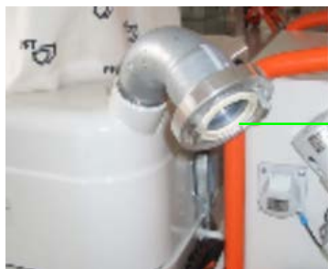
slika 19: Povezivanje creva za materijal
