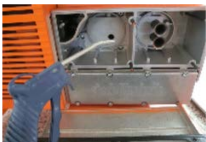
slika 62: Čišćenje kućišta filtera
