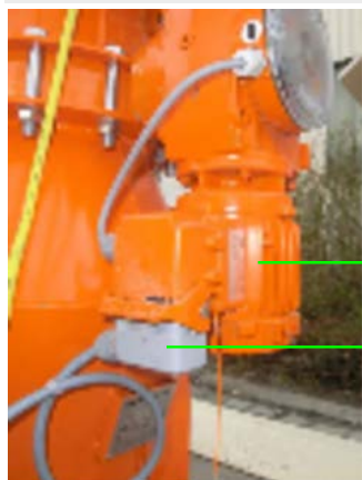
slika 17: Povezivanje upravljačkog kabela
