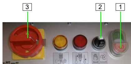
slika 27: Isključivanje mašine
