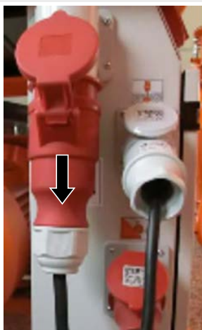
slika 29: Prekidanje električnog napajanja
