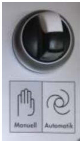
slika 12: Birač rotacionog kompresora
