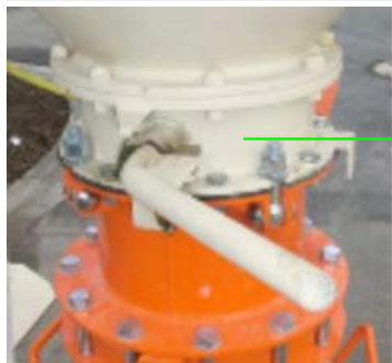
slika 39: Zatvaranje ispusnog poklopca silosa
