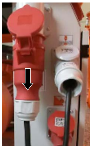
slika 44: Prekidanje električnog napajanja
