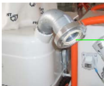
slika 19: Priključivanje transportnog crijeva
