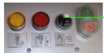
slika 42: Pražnjenje transportnih crijeva ispuhivanjem
