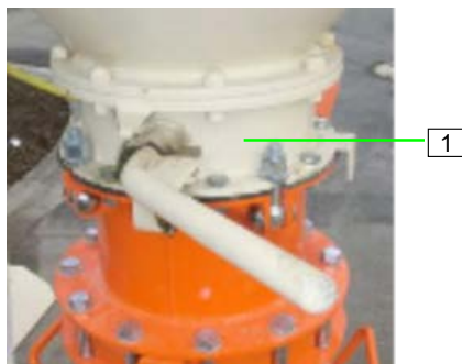
slika 22: Otvaranje izlazne zaklopke silosa
