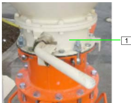
slika 32: Zatvaranje izlazne zaklopke silosa
