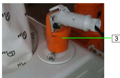
slika 16: Priključivanje upravljačkog kabela
