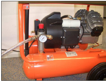
图 30: 连接空气软管
