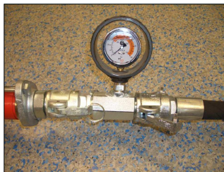
图 51: 砂浆压力为“0 bar”。
