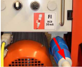
图 50: 取下连接电缆
