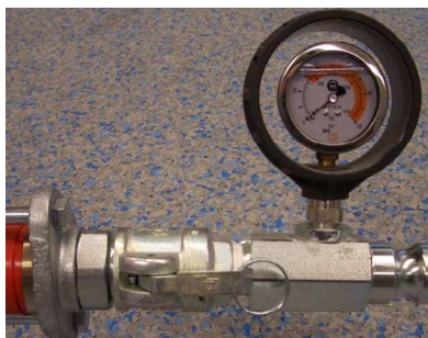
图 24: 连接砂浆压力计。
