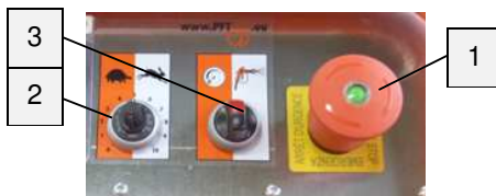
图 41：泵电机选择开关
