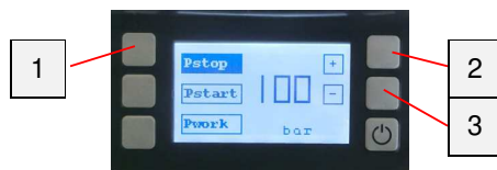
图 35: 切断压力 (Pstop)
