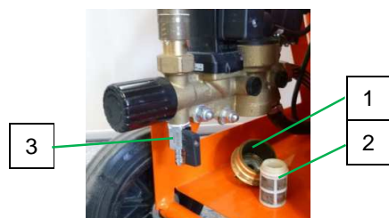
Fig. 39: Sita de reținere a impurităților
