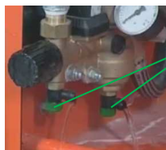
Fig. 108: Deschiderea robinetului de evacuare
