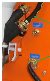
Fig. 106: Racordați furtunul de aer
