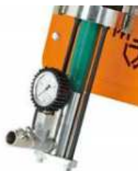
Fig. 29: Manometru presiune mortar
