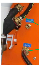
Fig. 109: Racordarea furtunului de aer
