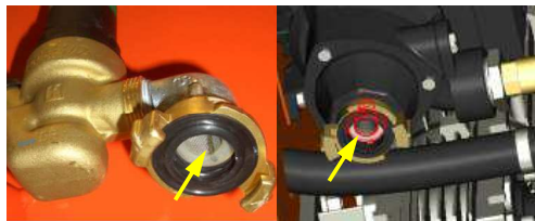
Рис. 47: Грязеулавливающая сетка в отверстии для впуска воды
