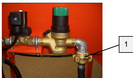
Рис. 15: Подключение воды без насоса для поддержания давления
