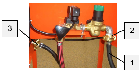
Рис. 44: Отсоединение подачи воды
