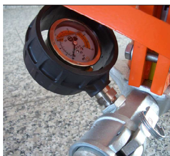
Рис. 26: Манометр давления раствора
