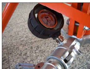
Рис. 50: Манометр давления раствора
