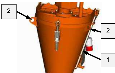
Рис. 19: Транспортировка с помощью крана
