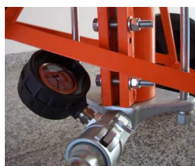
Рис. 16: Манометр давления раствора
