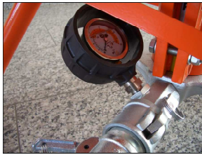
Рис. 51: Манометр давления раствора
