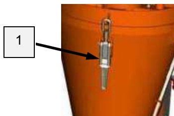
Рис. 21: Закрывать быстродействующий затвор
