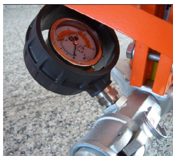
Рис. 27: Манометр давления раствора
