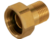
navojni priključak 1/2" VN, plosnati s proširenjem 3/4"
