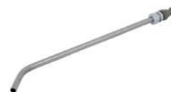
Rurka do badania konsystencji 13 część V
