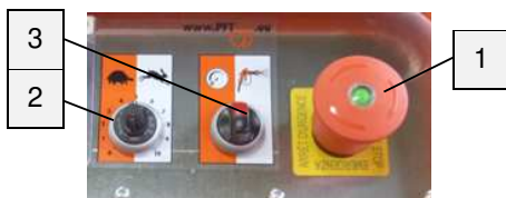
41. ábra: Szivattyúmotor választókapcsoló
