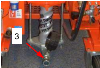
Abb. 54: Ablagerung Druckflansch
