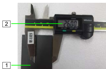
Фигура 53: Контролиране ширината на шибъра
