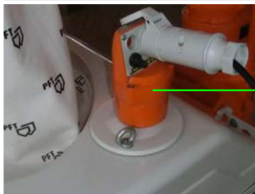
Фигура 16: Свързване на управляващия кабел
