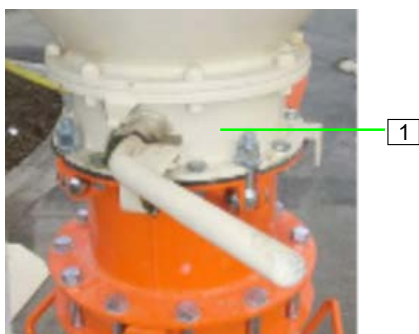
Фигура 32: Затваряне на клапата за изпразване на силоса
