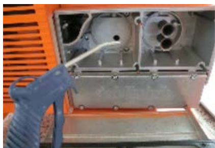
Фигура 62: Почиствяне на корпуса на филтъра
