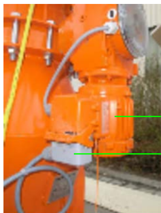
Фигура 17: Свързване на управляващия кабел
