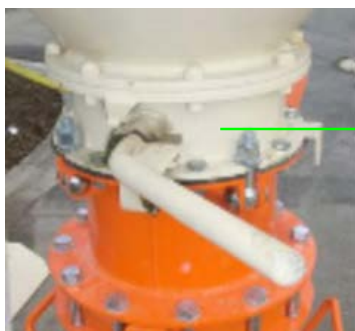
Фигура 22: Отворете клапата за изпразване на силоса
