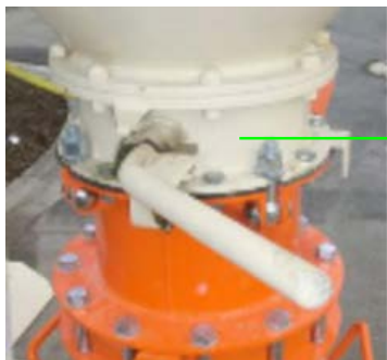
Фигура 39: Затваряне на клапата за изпразване на силоса
