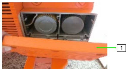
Фигура 59: Отваряне на капака на филтъра
