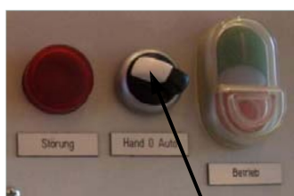
Obr. 28: Uvoľnenie tlaku
