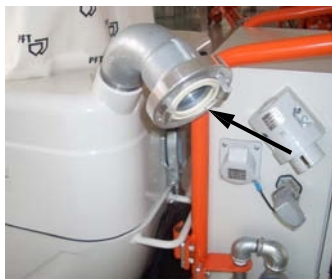
Obr. 13: Napojenie dopravnej hadice
