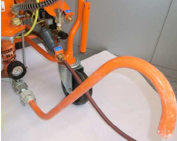
Мал. 48: Трубка для перевірки консистенції
