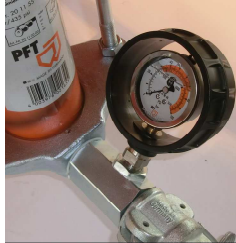
Мал. 26: Манометр тиску розчину
