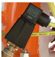
Мал. 101: Мембранний вимикач по воді
