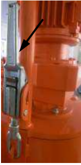
Şek. 33 Motor devirme flanşı açık
