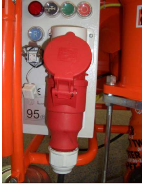
Şek. 30: Akım bağlantısının ayrılması
