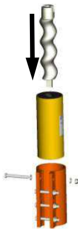
Şek. 31: Pompanın montajı
