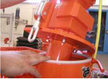
Şek. 32 Motor devirme flanşı ezilme tehlikesi
