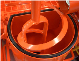
Şek. 38 Karıştırma helezonunun montajı
