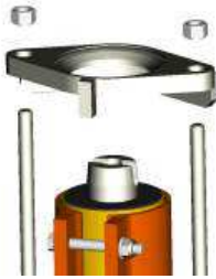
Şek. 36 Emme flanşının montajı
