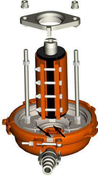
Şek. 28 Pompa sistemi takılmalıdır (Rotorun muylusu karıştırma kanadının takma yerine gelmelidir).
