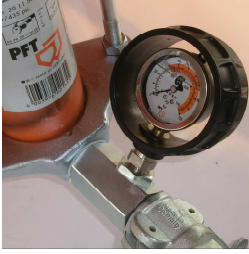
Şek. 26: Harç basıncı manometresi
