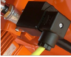
Şek. 102: Basınç anahtarı hava
