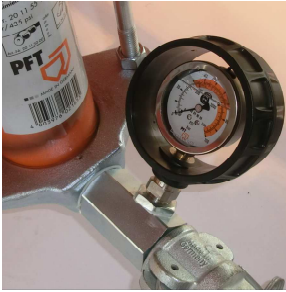
Şek. 42: Harç basıncı manometresi
