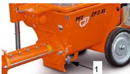
Obr. 35: Otevření čistícího krytu
