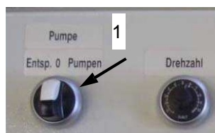
Obr. 31: Změna smyslu otáčení
