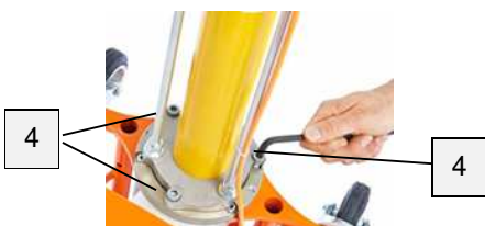
Obr. 69: Povolení šroubů
