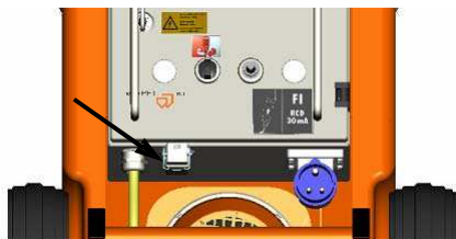
Obr. 23: Zapojení zaslepovací vidlice
