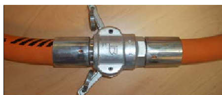
Obr. 36: Rozebrání spojů hadice
