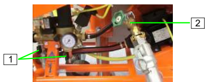
Obrázek 32: Uzavřete vypouštěcí kohout
