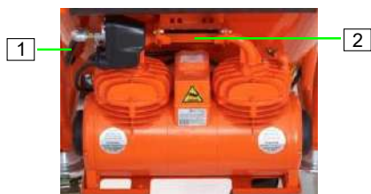
Obrázek 87: Odejměte vzduchový kompresor
