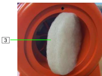
Obrázek 88: Filtr vzduchového kompresoru
