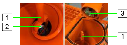
Obrázek 80: Použití míchací spirály
