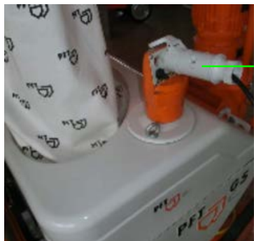
Obrázek 30: Vytážení řídicí zástrčky
