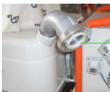
Obrázek 19: Připojení přívodní hadice
