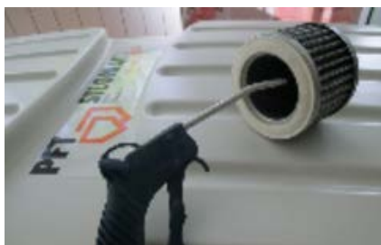
Obrázek 61: Vyčištění filtračních patron
