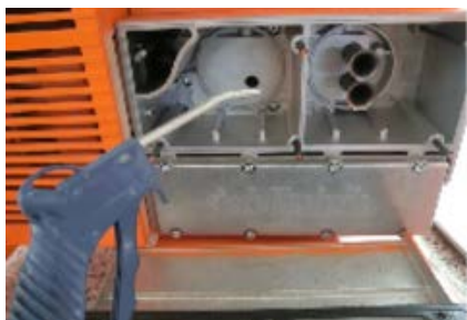
Obrázek 62: Čištění tělesa filtru
