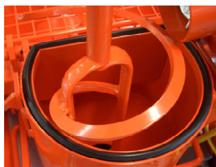
Fig. 38: Montar la hélice mezcladora
