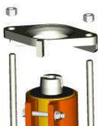
Fig. 36: Montar la brida de aspiración
