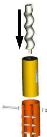
Fig. 31: Ensamblar la bomba
