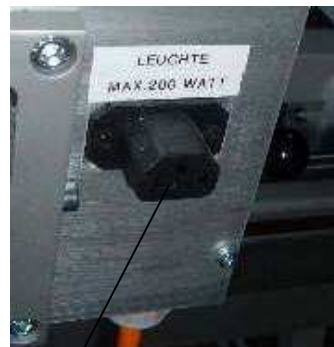
Enchufe para herramientas auxiliares en el lado posterior de la máquina, máx. 200 vatios
