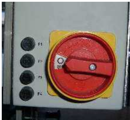
Interruptor principal 0-1 con disparador de tensión mínima.
