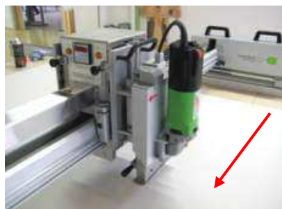
Fig. 11.05 Módulo de sierra transversal – derecho
