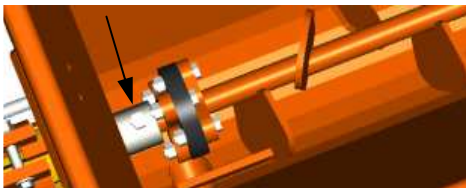
Fig. 44: Extracción de la bomba
