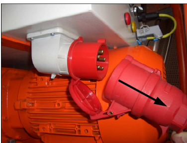
Fig. 40: Retirar el cable de conexión
