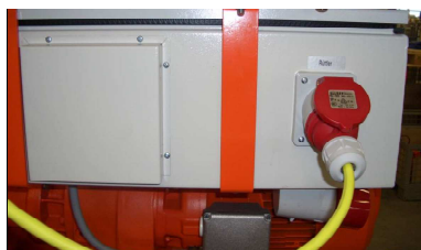
Fig. 20: Conectando el vibrador
