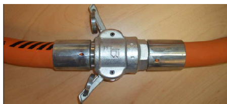
Fig. 37: Aflojando los acoples
