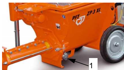
Fig. 35: Abriendo el acople de desagüe
