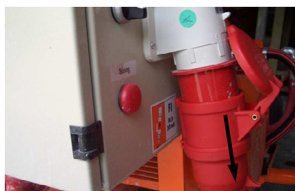
Fig. 59: Retirar el cable de conexión
