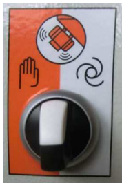
Fig. 17: Selector del vibrador
