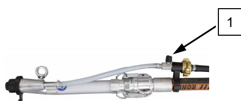
Fig. 35: Abrir la válvula de aire
