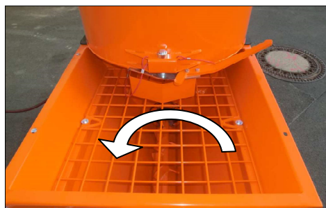
Fig. 30: Comprobar el sentido de giro
