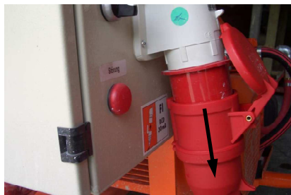
Fig. 75: Retirar el cable de conexión
