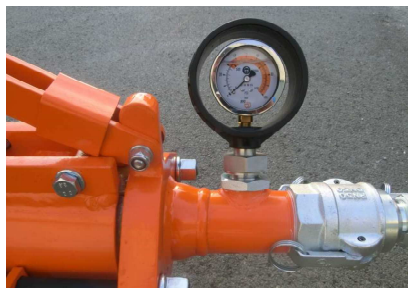
Fig. 23: Manómetro de presión del mortero
