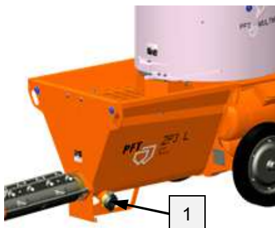
Fig. 66: Abrir la tapa de limpieza
