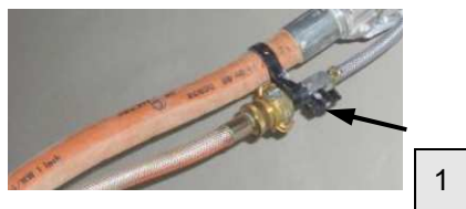
Fig. 51: Abrir la llave de aire
