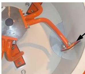
Fig. 77: Ajustar el brazo mezclador
