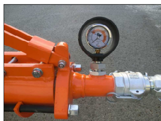
Fig. 18: Manómetro de presión del mortero
