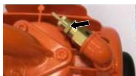
Figura 77: Válvula de seguridad
