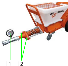
Figura 56: Revisar la presión del mortero y despresurizar
