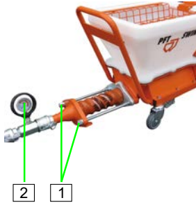
Figura 71: Revisar la presión del mortero y despresurizar
