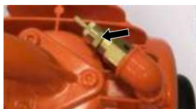
Figura 94: Válvula de seguridad
