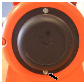
Figura 89: Apertura de la tapa del filtro
