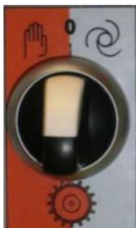
Figura 19: Selector de la rueda de celdas
