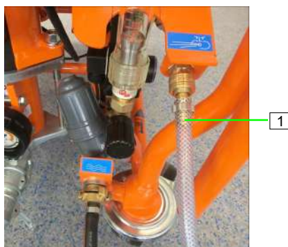
Figura 44: Conectar la manguera de aire
