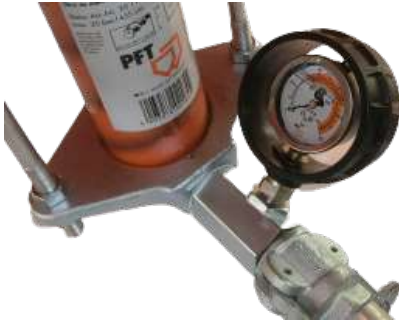
Figura 27: Manómetro de presión de mortero
