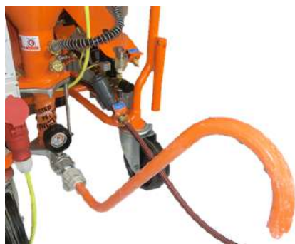
Figura 53: Tubo de prueba de consistencia
