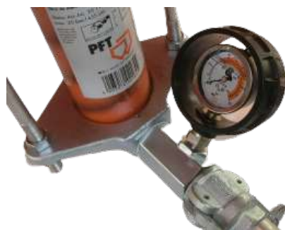
Figura 17: Manómetro de presión de mortero
