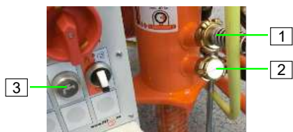
Figura 44: Irrigación de la zona de mezcla
