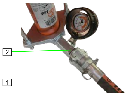
Figura 46: Conexión de la manguera de mortero
