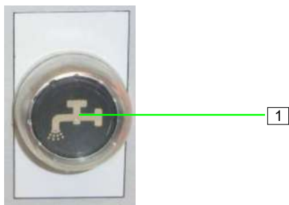
Figura 42: Accionar el pulsador de avance de agua
