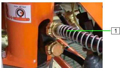
Figura 80: Conectar la manguera de agua
