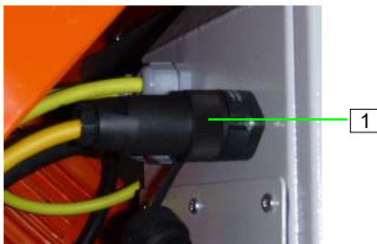
Figura 75: Desactivar sonda de nivel
