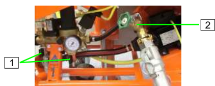
Figura 37: Cierre la llave de vaciado
