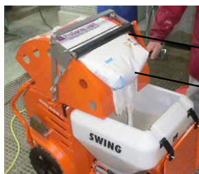
Slika 30: Pražnjenje vreće sa materijalom
