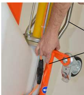
Slika 67: Uklanjanje ručke
