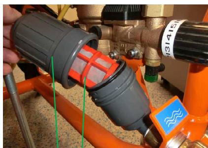
Slika 99: Čišćenje sita
