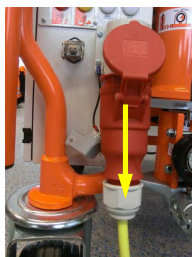
Slika 95: Uklanjanje kabla za struju
