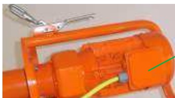
Slika. 29: Pozicija nagibnog prekidača
