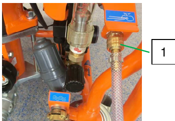
Slika 55: Priključivanje creva za vazduh
