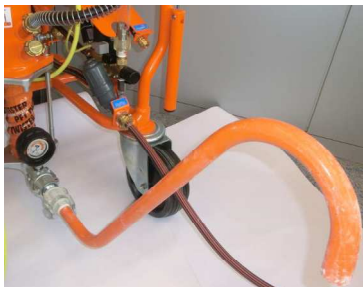
Slika 48: Cev za ispitivanje konzistencije
