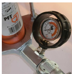
Slika. 26: Manometar pritiska maltera
