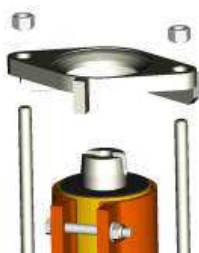
Рис. 36: Установка всасывающего фланца
