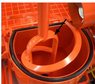
Рис. 34: Снятие смесительной спирали
