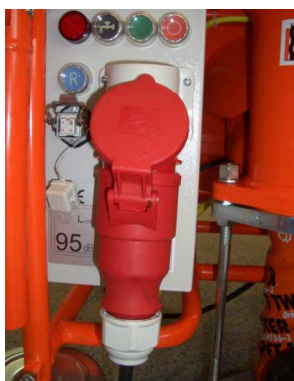
Рис. 30: Отсоединение электрического подключения
