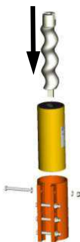
Рис. 31: Сборка насоса
