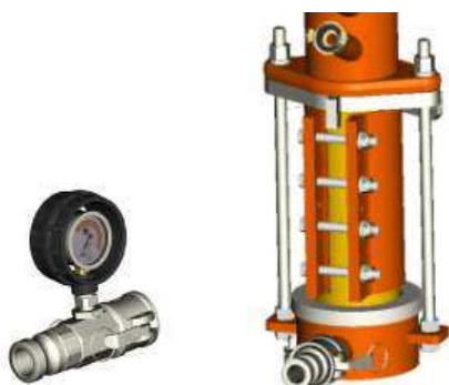
Рис. 37: Установка домешивателя и манометра для раствора.
