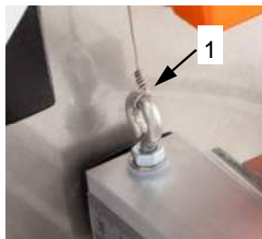
Рис. 37 Нижний блок крепления
