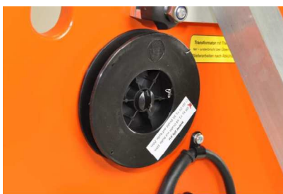
Рис. 35 Запасная режущая проволока
