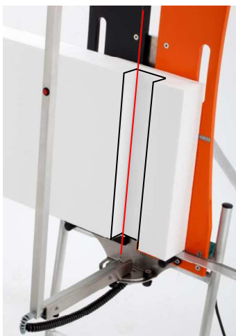
Рис. 6 Вырезание выемки
