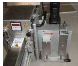
Рис. 11.07 Пила для выборки пазов вдоль
