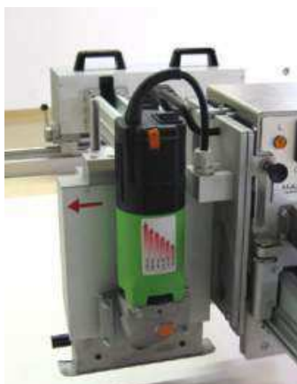
Рис. 15.02 Отрезной агрегат продольный
