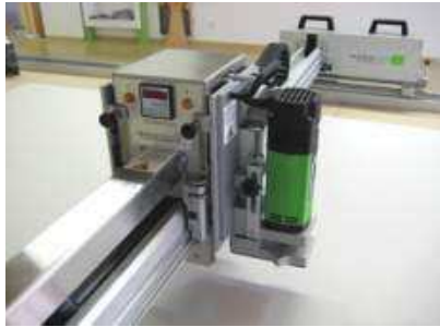
Рис. 11.01 Фрезерный агрегат справа
