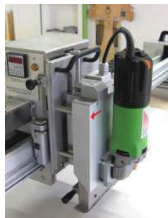
Рис. 15.03 Отрезной агрегат поперечный
