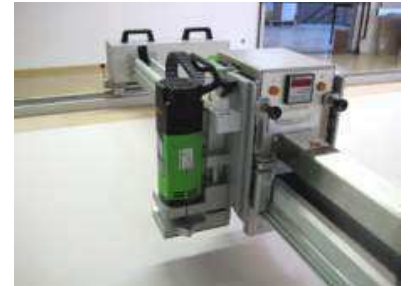
Рис. 11.02 Фрезерный агрегат слева
