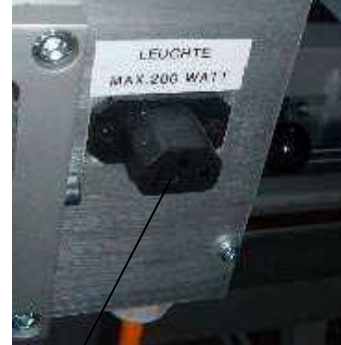
Вспомогательная розетка - на обратной стороне станка, макс. 200 Ватт.
