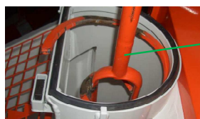
Рис. 89: Снятие смесительной спирали
