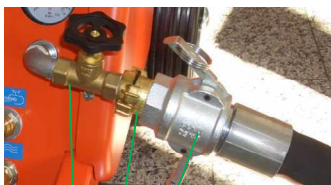
Рис. 52: Подготовка рукава подачи раствора
