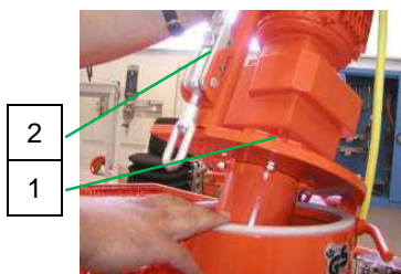
Рис. 82: Закрывание откидывающегося фланца
