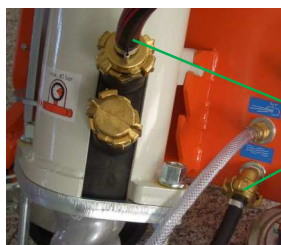
Рис. 88: Отсоединение подачи воды
