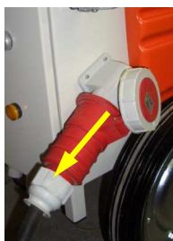
Рис. 93: Демонтаж соединительного кабеля
