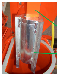
Рис. 80: Использование очистителя для очистки смесительной башни
