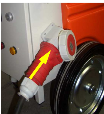
Рис. 32: Подключение электропитания
