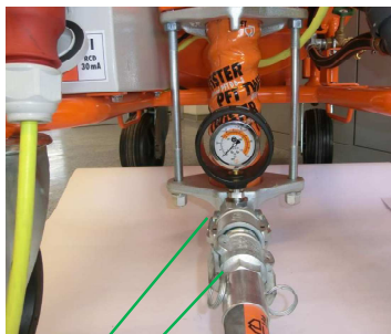
Рис. 55: Подключение рукава для подачи раствора
