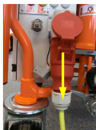
Рис. 97: Удаление соединительного кабеля
