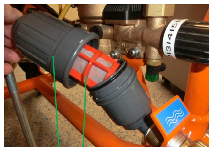
Рис. 101: Очистка сетки
