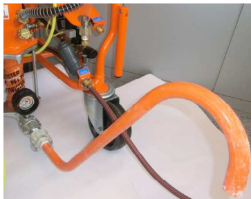
Рис. 50: Труба для контроля консистенции раствора
