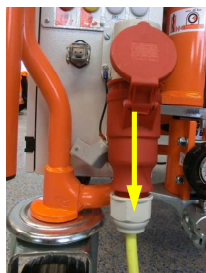
Рис. 95: Удаление соединительного кабеля
