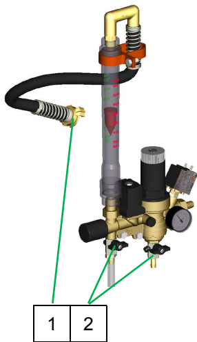
Рис. 90: Отсоединение подачи воды
