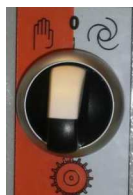
Рис. 74: Выключение подающего барабана
