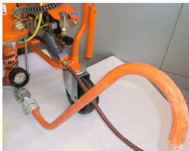
Рис. 48: Труба для контроля консистенции раствора
